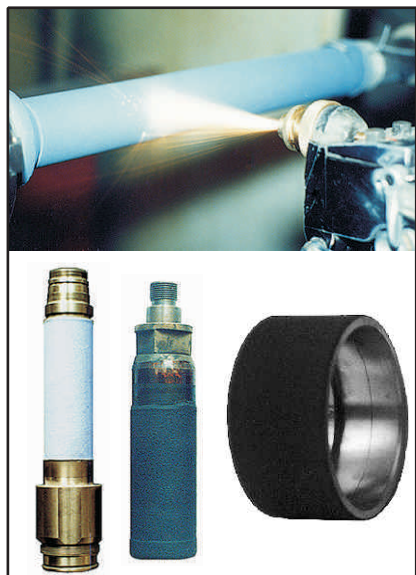
Рис. 3. Детали насосного оборудования (плунжер, штоки, защитная втулка) с напыленными покрытиями серии "Сфекорд-Керамика".
